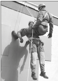
Voorbeeld: Evacuatie met Milan afdaalapparaat.
